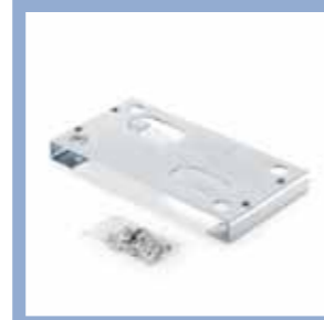
Placa de cimentación elevada incluida. Fijación al suelo interje de 260 x 117, n.4 Ø 11, interje de fijación del motor 300 x 75 n.4 M8
