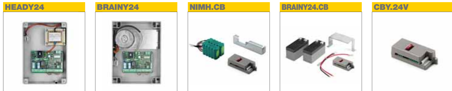
HEADY24 Central de mando de 24 V DC para cancelas de hojas batientes. Programación de lógicas de funcionamiento a través de la pantalla, receptor 433,92 Mhz incorporado de 64 códigos. (características completas pág. 162). Sólo para modelos BOB2124,BOB3024,BILL24 BRAINY24 Central de mando de 24 V DC para cancelas de hojas batientes con lógicas de funcionamiento múltiples. Programación desde la pantalla, receptor de 433,92 Mhz incorporado de 64 códigos (características completas pág. 162) NIMH.CB Accesorio compuesto por una tarjeta carga-baterías CBY.24V, por baterías NIMH y soporte BRAINY24.CB Accesorio para BRAINY24 con carga de baterías CBY.24V, baterías 1,2 Ah y soporte. CBY.24V Tarjeta carga-batería La tarjeta CBY.24V permite cargar dos tipos distintos de baterías de níquel-hidruro metálico y plombo
